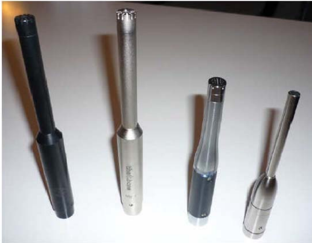
Figura 5.2.1 Microfoni di misura (da sinistra a destra): Haun MB550, T-Bone MM1, NTI M2210, Audix TM-1.
