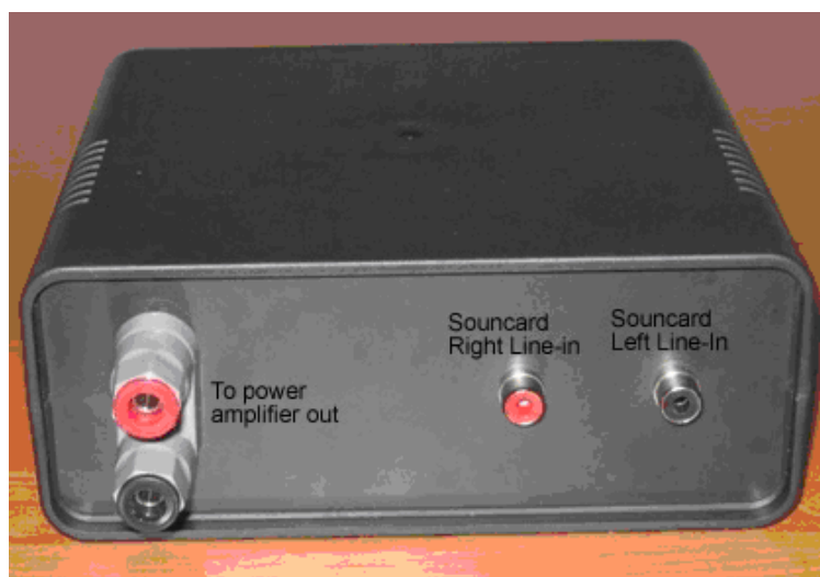
Imagen 3.2.: Parte posterior de la caja de medición ARTA
