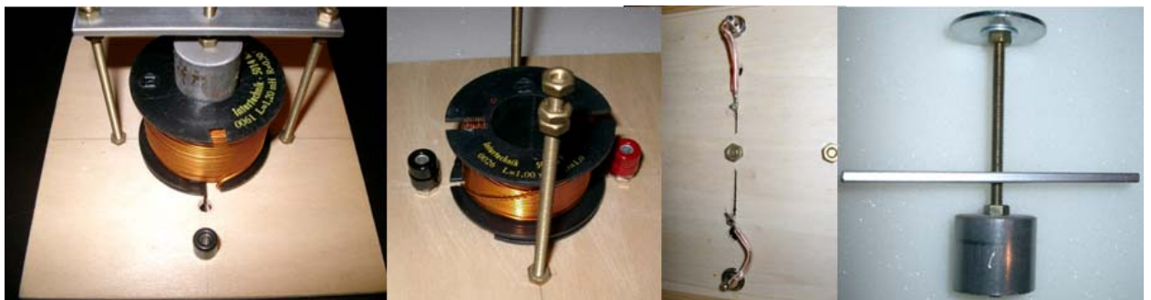
Imagen 13.1-5: Detalles de construcción de la bobina variable
