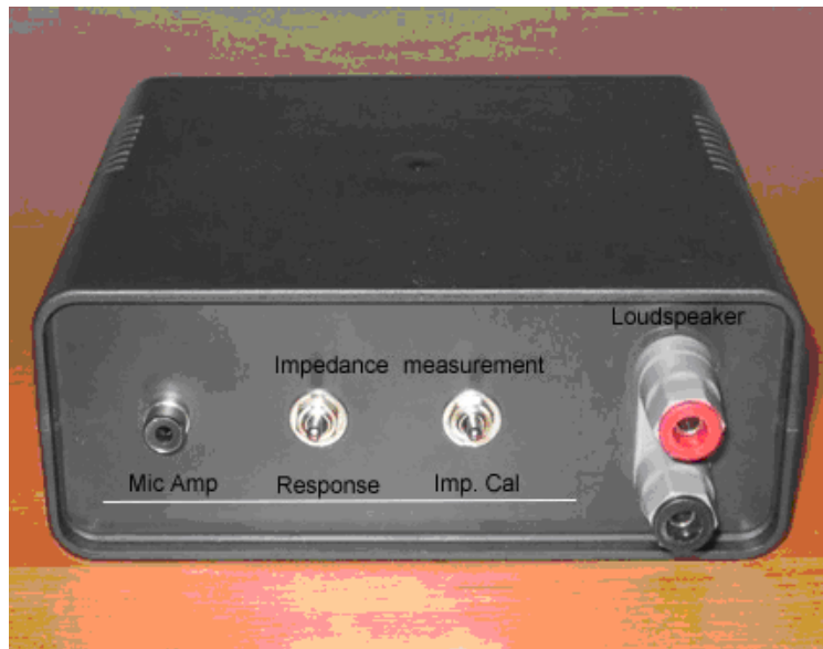
Imagen 3.1.: Vista frontal de la caja de medición ARTA
