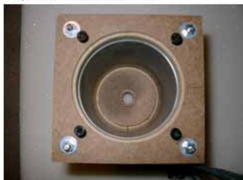
Bild 3.6: Rückwand (Treiberseite), Außenansicht mit Nut zum Einsetzen des Treibers
