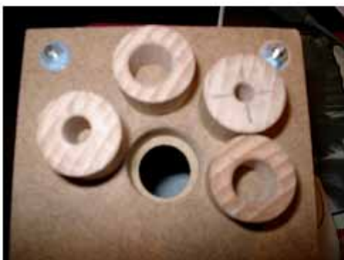
Bild 3.5: Vorderseite (Mikrofonseite) mit Loch für Mikrofonadapter aus 25 mm Rundstab
