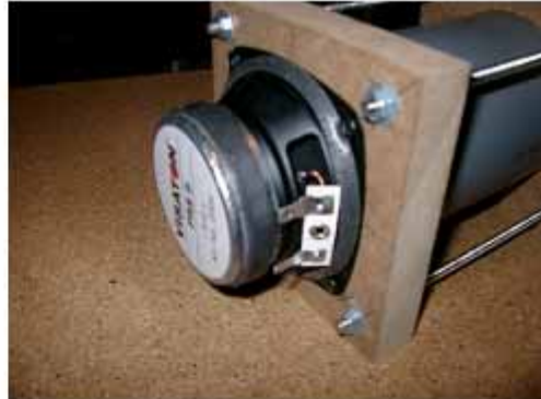
Bild 3.2: Rückansicht der fertigen Messkammer mit Treiber
