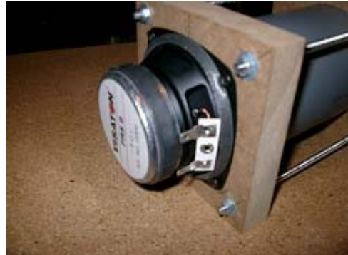
Ilustración 3.2. Vista posterior de la cámara finalizada con altavoces.
