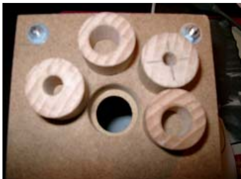
Ilustración 3.5 Vista frontal (micrófono) con un orificio para el adaptador del pasador de 25 mm para los micrófonos.
