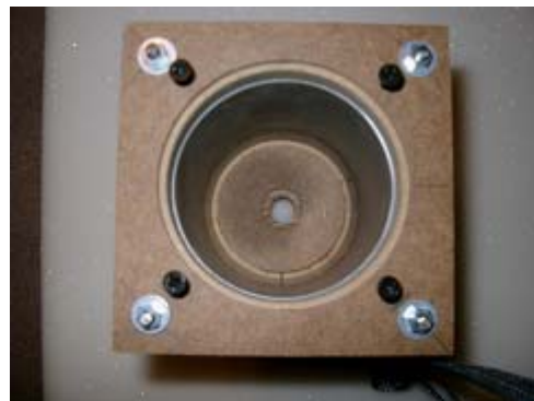
Ilustración 3.6 Panel posterior (lado del altavoz), vista exterior con la tuerca insertando el altavoz.
