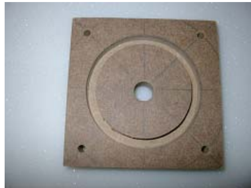
Ilustración 3.4 Vista frontal (interior) con carril para acoplar la tubería.
