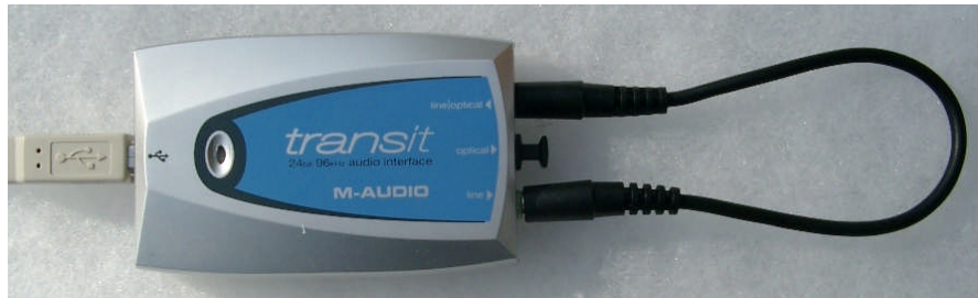
Loopback Kabel z.B. Pollin Audio Verbindungskabel Stereo, 3,5 mm Klinkenstecker auf 3,5 mm Klinkenstecker. Länge 0,3 m. Best.Nr. 560 824
