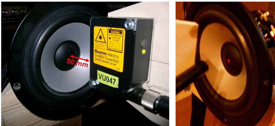
Bild 5: Anordnung von Distanzsensor und Mikrofon vor der Membran
