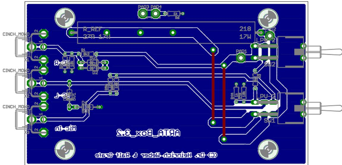
**Bild 1.1.2:** Bestückungsseite der Platine für die ARTA-Messbox
