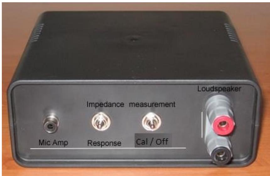
Bild 1: Vorderansicht der ARTA-Messbox.
