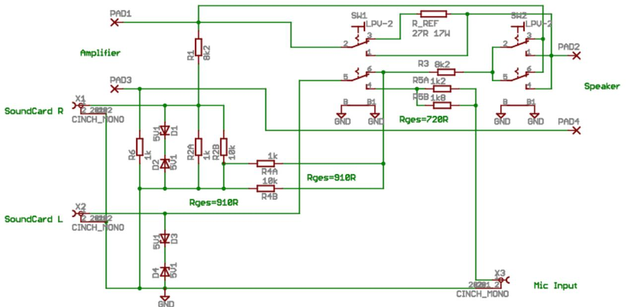
**Bild 1.1.3:** Schaltplan für die Platinenlösung der ARTA-Messbox
