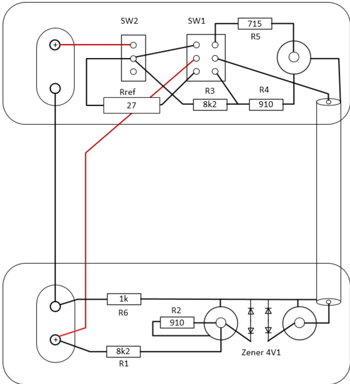
Bild 4: Aufbauplan für die ARTA-Messbox
