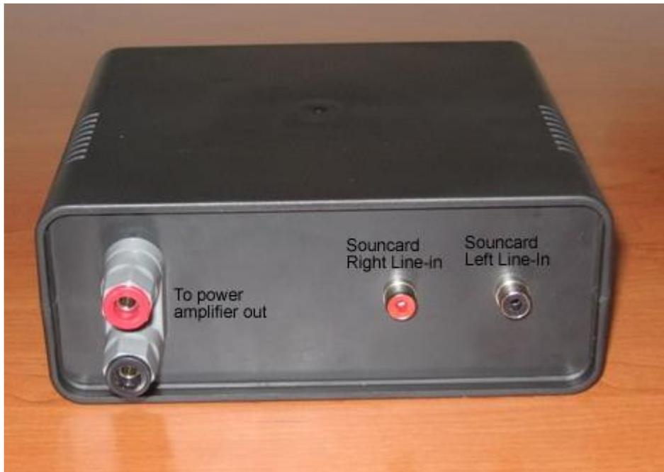
Bild 2: Rückseite der ARTA-Messbox.
