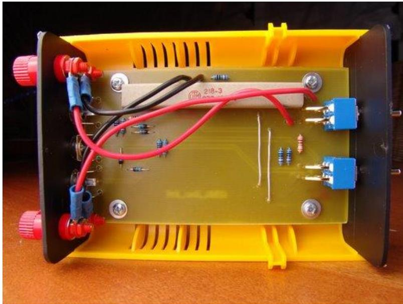
**Bild 1.1.1:** Die Platinenlösung der ARTA-Messbox
