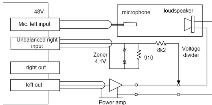
Bild 7: Verkabelung für zweikanalige Frequenzgangmessungen
