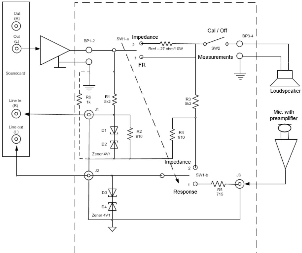
**Anm. 1** Die Masse des Leistungsverstärkers und der Soundkarte sind durch einen 1k Widerstand getrennt.
